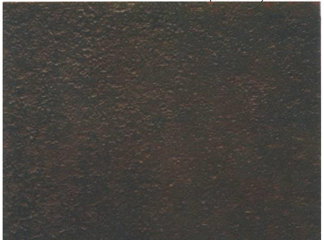
Plieno paviršius nuvalytas D St 3 klasės
