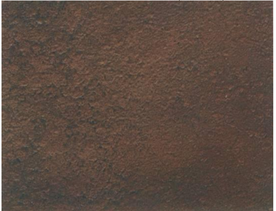
Plieno paviršius nuvalytas D St 3 klasės
